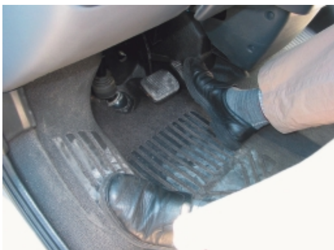
Kupplung Ade: Weniger Arbeit für den linken Fuß ist einer der Hauptvorteile des ASG.
