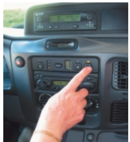
Das Durashift-Getriebe von Ford wird über Tasten im Armaturenbrett geschaltet. Im Ford zeigt das Display auch im Automatik-Modus den gerade angezeigten Gang an. Mit den Tasten im Lenkrad ist der manuelle Eingriff möglich.
