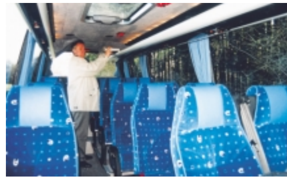
Dank 2,20 m Außenbreite besitzt der Fahrgastraum des Super Sprinter eine überraschende Großzügigkeit und breite Omnibussitzen in 3er-Reihen.
