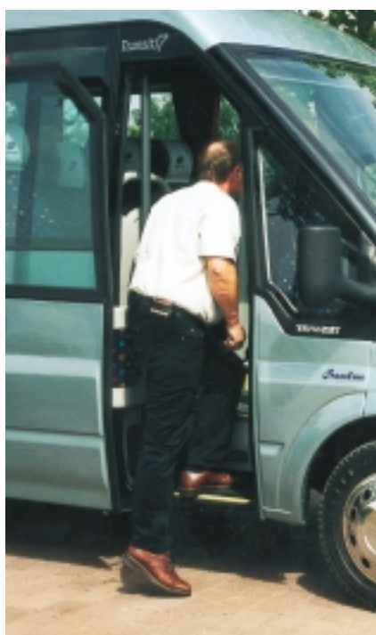
Der großzügige Fahrgasteinstieg besitzt eine bequeme Trittstufenhöhe und ist über günstig platzierte Haltestangen gesichert.
