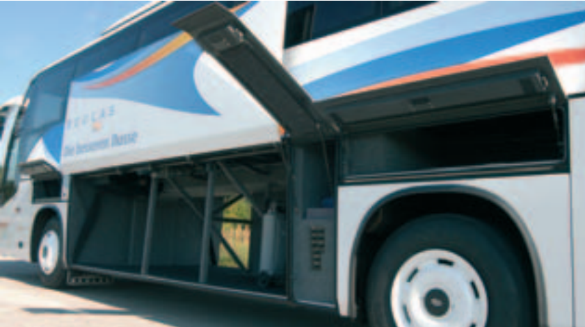
oben: 9,5 m 3 Kofferraum, eine riesige Klappe links mit pneumatischem Schließmechanismus
