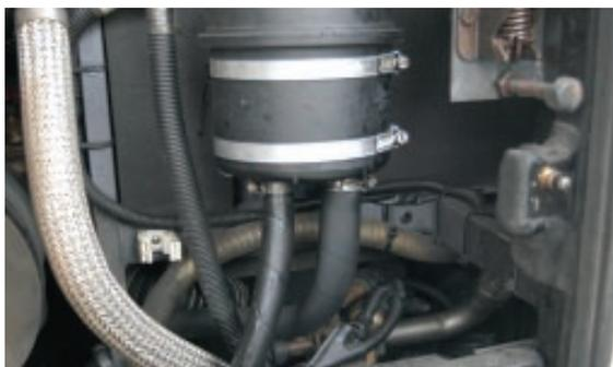
(von oben links nach unten rechts) Gut bei Kräften, sauber und trocken: Der Euro 2-Sechszylinder von DAF mit 370 PS macht im 18-Tonner eine gute Figur. Schwitzender Ausgleichsbehälter für die Servolenkung
