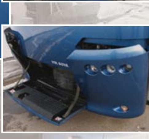
(Foto rechts) An der Front ist alles gut zugänglich – die Unfallforscher kritisieren die Batterien im vorderen Aufprallbereich.
