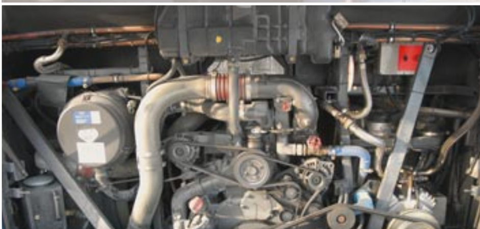
Stehend im Heck der 12,6 l große DAF-Sechszylinder – für kalte Wintertage empfiehlt sich die optionale Kraftstoff-Filterheizung.
