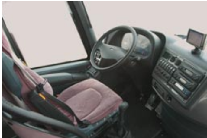
Mit der Lenkrad-Neigung wird im Bova Magiq auch der Instrumententräger verstellt.
