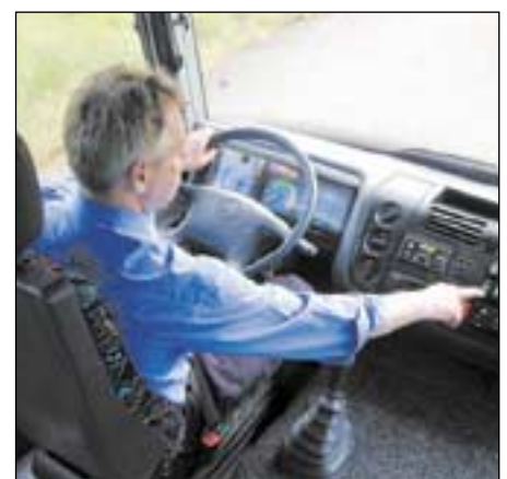
Nachteilig beim sonst erstklassig gestalteten Fahrerplatz ist das zu weit entfernte positionierte Bedientastenfeld.
