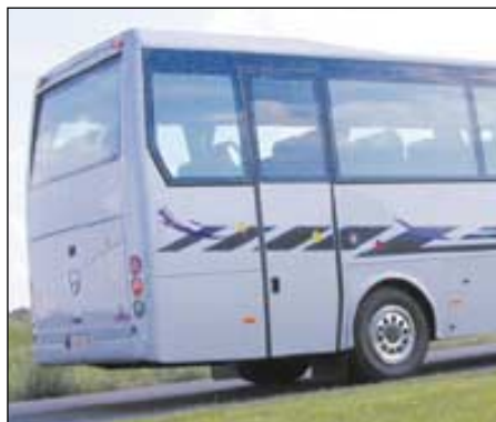
Mit einem Kofferraumangebot von etwa 3,6 \text{ m}^3 steht beim 30-Sitzer ein adäquates Volumen von 120 \text{ l} pro Person zur Verfügung.
