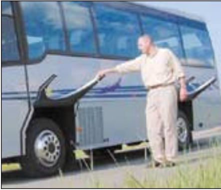
Der Sundancer zeigte sich als zugänglicher Typ mit Service-Klappe vorn und aufklappbaren Radläufen.
