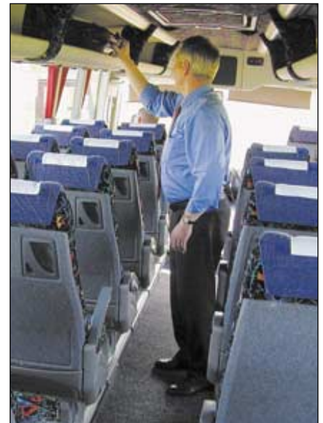
Eine Mittelgangstehhöhe von rund 2,0 \text{ m} , Gepäckablage, Düsenbelüftung sowie Leselampen kennzeichnen den Reisebuskomfort.
