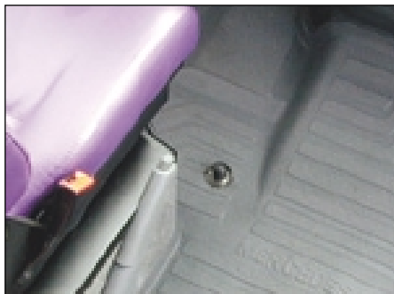
Ungünstig: der Fußschalter für die Motorbremse rechts hinter dem Gaspedal
