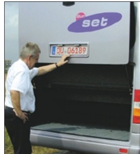
Gut gelöst: die parallel zum Heck öffnende Kofferraumklappe
