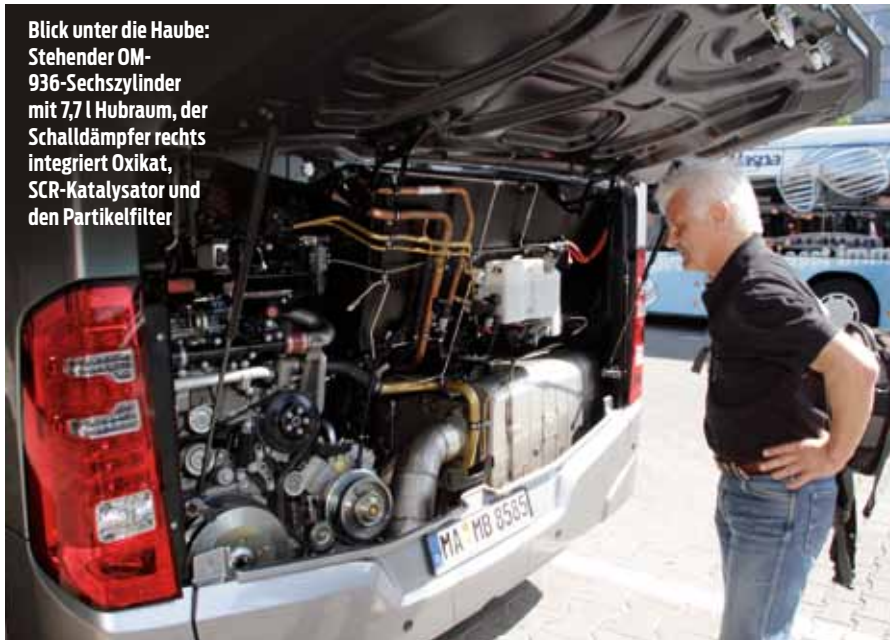
Motorturm mit vielen Klappen und Öffnungen – die Mechaniker werden es zu schätzen wissen.
