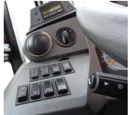
Neuer Armaturenräger, die Lichtschalter sind links platziert.
