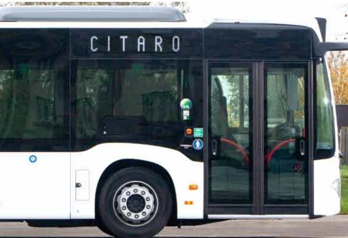
Der Citaro kann auch kleiner. Für 10,6 m Länge wird der Radstand gekürzt
