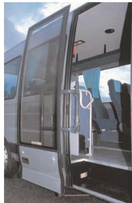
Die große, komplett verglaste Außenschwingtür wird elektrisch getrieben geöffnet.
