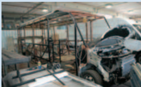
Bis zur Vorderachse VW, dahinter die Omnibusstruktur von Lito.
