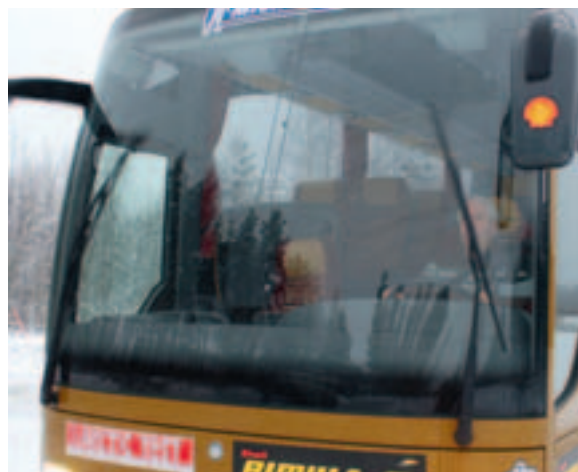
Ein großer Keil in Scheibenmitte bleibt ungewischt – ein dritter Wischerarm am Dachrand fehlt.
