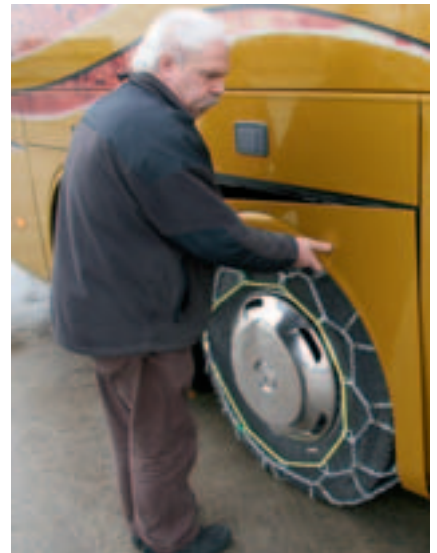
Schnelle Schneekettenmontage mit einfach demontierbarem Radlauf
