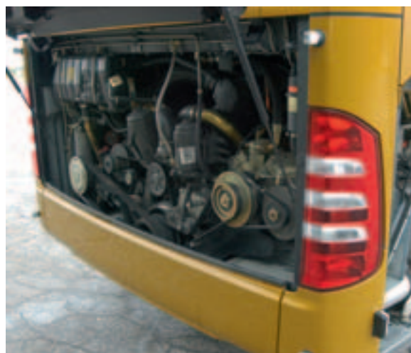
Im Heck der leistungsfreudige Reihensechszylinder OM 457 LA mit 428 PS und 2.100 Nm
