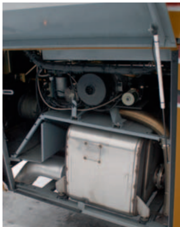
Winterfeste Blue-tec-Abgasanlage mit Heizung für Tank und Leitungen, Druckluft reinigt die Einspritzdüsen.
