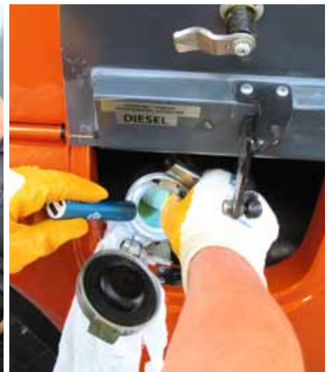
Von oben: Bis zu 80 km/h in der VDA-Ausweichgasse: Wir haben keinen unsicheren Kandidaten gesehen, um die aktive Sicherheit ist es gut bestellt. Immer wieder das Abstimmungsgespräch: Jeder Tester hat genau definierte Aufgaben. Millimetergenaue Tankung zu Beginn und zum Finale: Nur so lässt sich der Kraftstoffverbrauch exakt messen.
