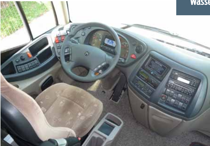
Wohnlich heller Innenraum mit üppiger Bestuhlung; Kommandostand aus einem Guss – mit großem Multifunktionslenkrad, AS-Tronic und stehendem Bremspedal
