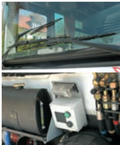
Mehr Sicht durch den dritten Scheibenwischer für das Sichtfeld des rechten Spiegels. Praktisch für die Werkstatt – Start-Stop-Schalter für den Motor im Heck.
