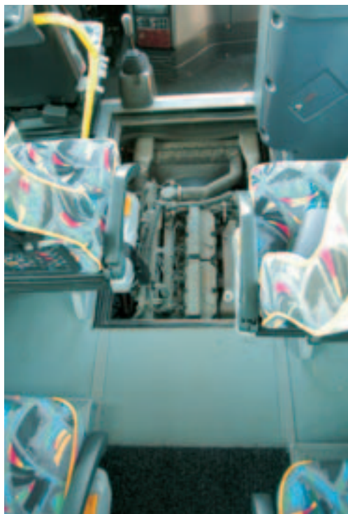
Vollwert-Vierzylinder mit 180 PS – schlecht zugänglich über die Bodenklappe (Foto 1.); leistungsfähig und wendig – als Schulbus in der Region nicht zu schade (Foto u.)
