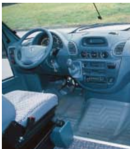
Moderner Arbeitsplatz vom aktuellen Sprinter, keine Lenkradverstellung, als Besonderheit mit Federspeicher-Feststellbremse.
