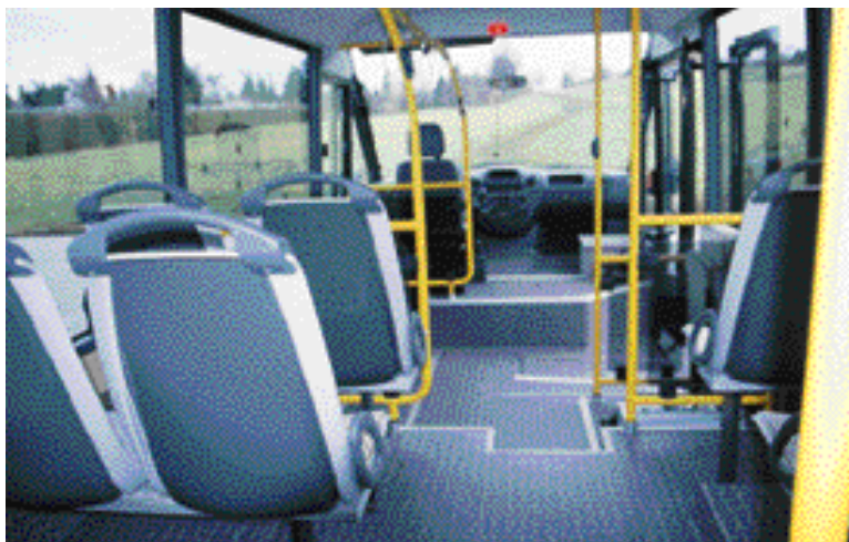
Großflächig Niederflur in Fahrzeugmitte, über zwei Stufen ist das bestuhlte Heck begehbar.
