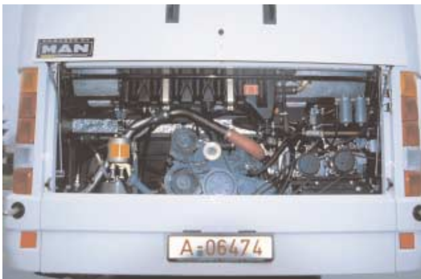
Mit „Sechs-Appeal“ im Heck – kräftiger Reihensechszylinder von MAN mit 220 PS und 850 Nm Drehmoment
