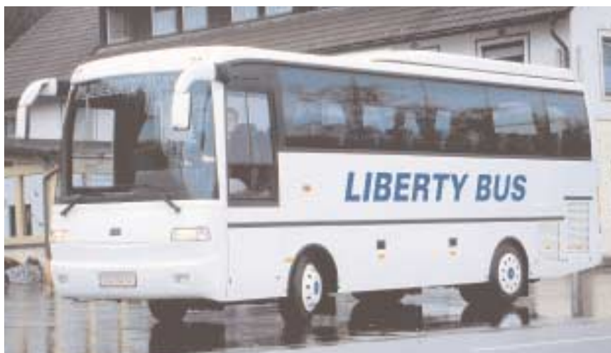
Mit 34 Sitzplätzen ein „kleiner Großer“, im Heck 220-PS und luftgefederte Achsen
