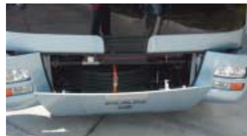
So soll's sein: Das Reserverad ist verkehrssicher im Bug untergebracht, die Klappentechnik sorgt für einfachen Birnenwechsel.
