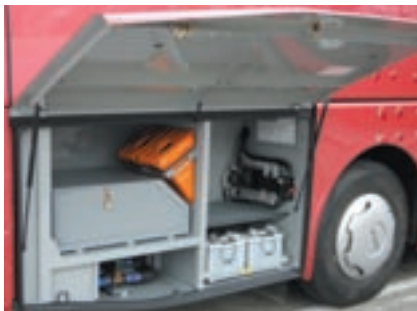
Rechts im hinteren Überhang die Batterien und die E-Zentrale mit Steuergeräten
