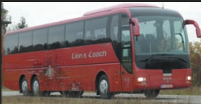
Viel Omnibus fürs Geld, doch kein Superhochdecker – Lion's Coach L mit 57 Sitzplätzen, 11,5 m 3 Kofferraum und 460 PS Motorleistung
