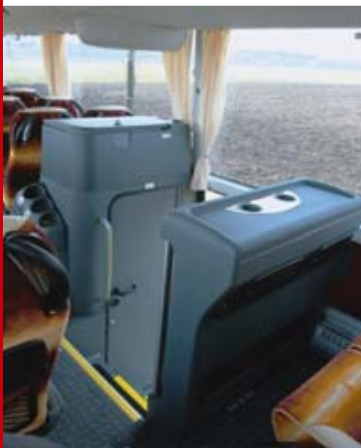
Komplettausstattung mit Toilette und Bordküche – praktisch das absperrbare Fach darüber
