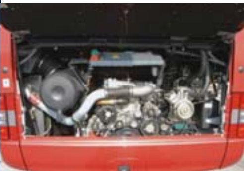
Der Motor: Euro 4 mit offenem PM-Kat
