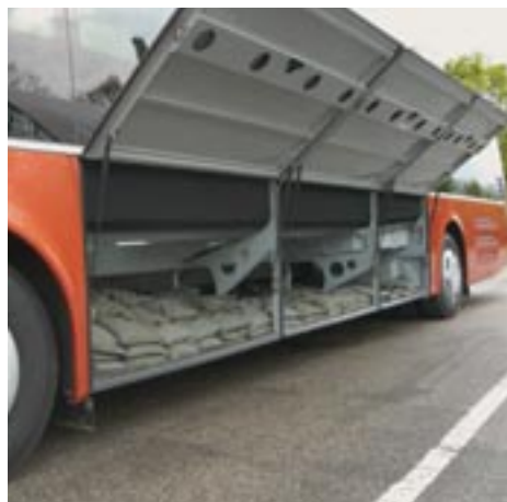
Die Kofferklappen aus Kunststoff an Scharnieren montiert – dahinter 5,6 m³ Stauraum.
