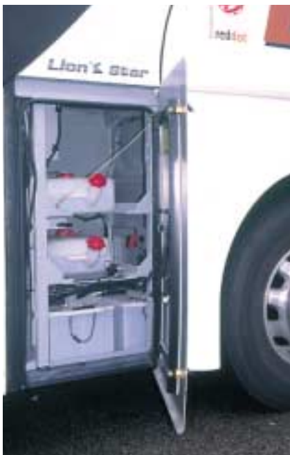
Der Kraftprotz, mittig stehend im Heck (oben) Aus Gewichtsgründen vor die Vorderachse platziert: Batterien und Waschwasser
