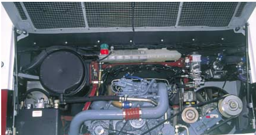
Der Kraftprotz, mittig stehend im Heck (oben) Aus Gewichtsgründen vor die Vorderachse platziert: Batterien und Waschwasser
