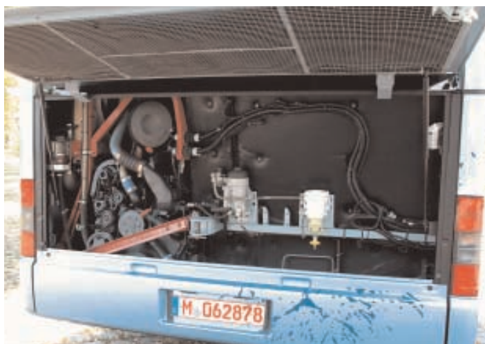
Kraftquelle links stehend im Heck: Reihensechszylinder D 0836 mit Common-Rail-Direkteinspritzung und 280 PS, Nebenaggregate und Kühlung über dem Motor angeordnet.
