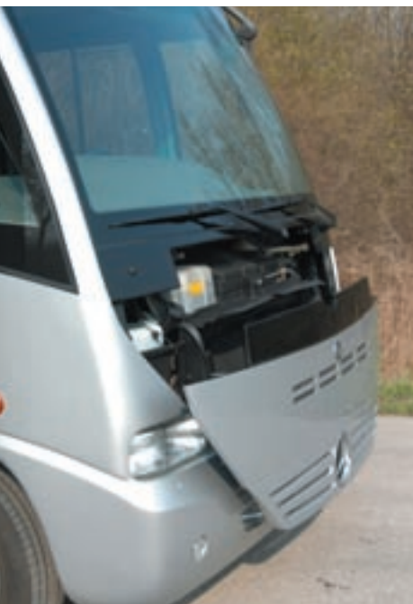
Hinter der klappbaren Bugklappe Ölmesstab und Kühlwasserbehälter, gut zugänglich das Wischergestänge
