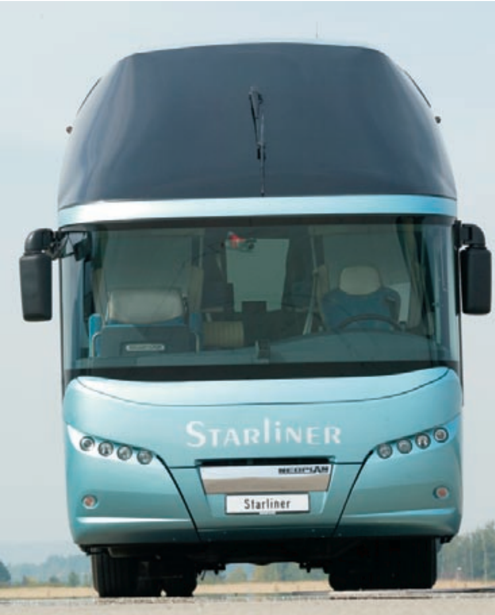
Ein Charakterkopf als Markenzeichen – mit Bi-Xenon-Kurvenlicht und Scheibenwischer in der dunkel getönten Verglasung
