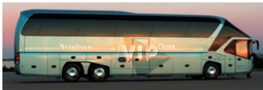
Die riesige Seitenansicht wird durch Fensterflächen, Sicke, Lichtkanten und ineinander laufende Linien klar gegliedert.
