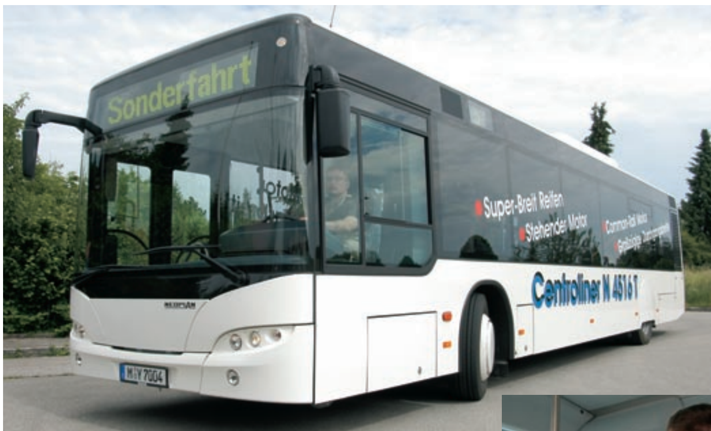
Mit moderner MAN-Großserientechnik und Designer-Kleid: Neoplan Centroliner N 4516 T mit drei Türen, Common-Rail-Diesel in Turmbauweise und Single-Bereifung an der Hinterachse
