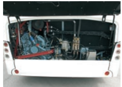
Links stehend verbaut: kleinvolumiger Common-Rail-Sechszylinder mit 280 PS und 1.100 Nm maximalem Drehmoment
