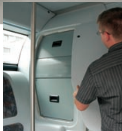
Doppelte Schallisolierung nach innen – Motor und Nebenaggregate sind auch von innen zugänglich.
