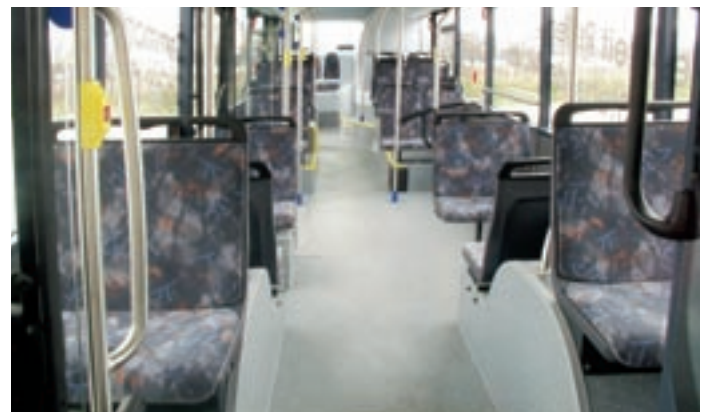
Beispielhafte Raumökonomie für hohe Kapazität zu Spitzenzeiten, breite Durchgänge zwischen den Achsen, große Stehplattformen.
