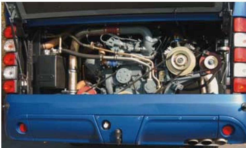
Stehender MAN-Reihensechszylinder mit Hydrostat-Lüfter, motorfester Klimakompressor
