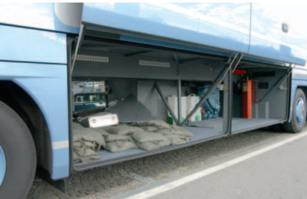
Gute Lichtausbeute mit Xenon-Scheinwerfern, das Cockpit ist gut ausgeleuchtet. Mit 9,4 m 3 groß genug für die Fernreise – vorbildlich die automatische Feuerlöschanlage.
