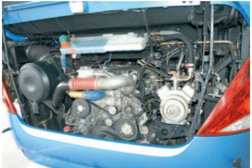
Unter der Klappe stehend montiert: 10,5 Liter Hubraum, 440 PS, 2.100 Nm maximales Drehmoment. Breite sichere Einstiege – gesichert mit kräftigen Handläufen (unten links) Lieblas auf der Toilette montiert der abwischbare Stauschrank (unten rechts)
