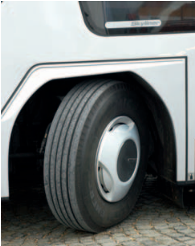
Große 315er-Bereifung für mehr Tragfähigkeit an der Vorderachse – auch von hinten keine stiefmütterliche Ansicht
