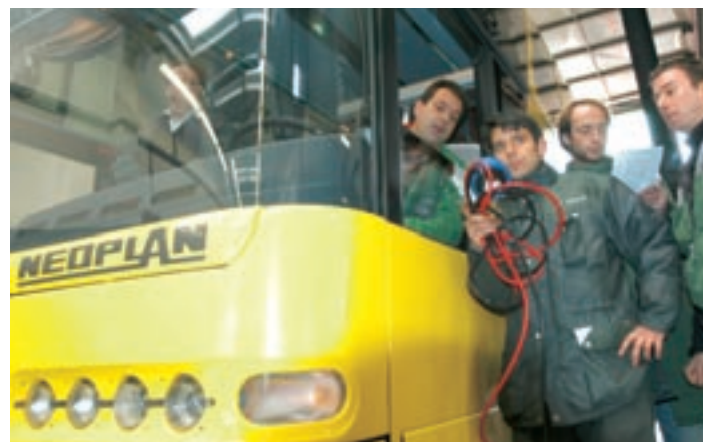
Überprüfung der Druckluftanlage – der Dekra-Sachverständige Klaus Trapp nutzt den Test für eine Nachwuchsschulung.
