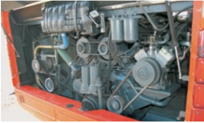
Kraftzentrum im Heck – der Daimler-V8 schiebt in Vollbesitz seiner 381 PS mit Nachdruck an.
