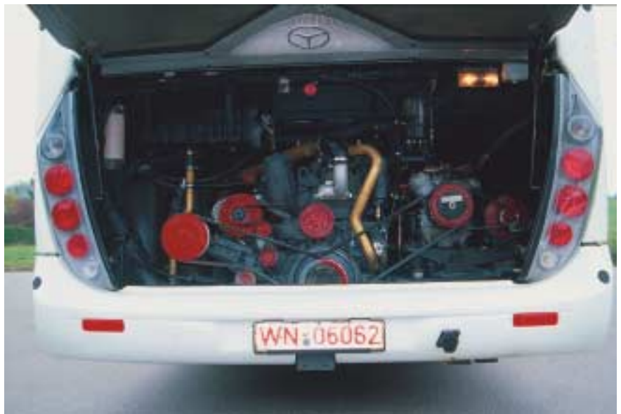
Stehend im Heck: der Reihensechszylinder OM 457 LA mit Vierventil-Zylinderkopf, Pumpe-Düse-Einspritzung und 422 PS Nennleistung, maximales Drehmoment: 2.000 Nm
