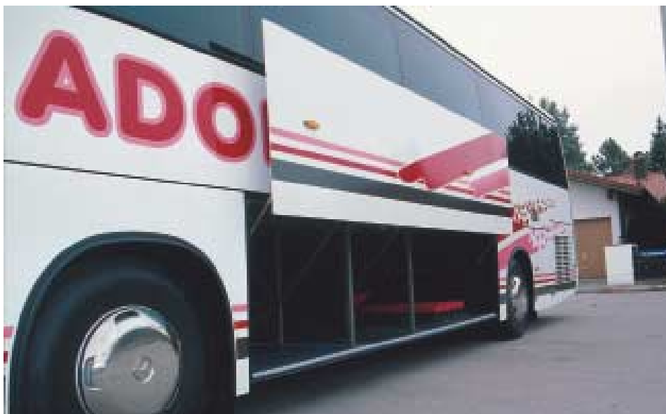
Große einteilige Kofferklappen links und rechts, auf Wunsch pneumatisch zu betätigen
