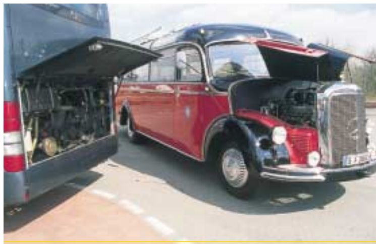
Auf den Spuren des Fortschritts: Vom Hauben-Omnibus mit 90-PS-Frontmotor zum Reisehochdecker mit 422-PS-Heckmotor
