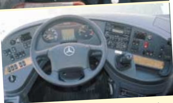
Großes Vierspeichen-Lenkrad, links die Heizklappen zum Motorraum, der lange Schaltstock geht gut zur Hand (oben) Moderner Arbeitsplatz: Mit Tacho und Drehzahlmesser, Joystick-schaltung und Display (unten)
