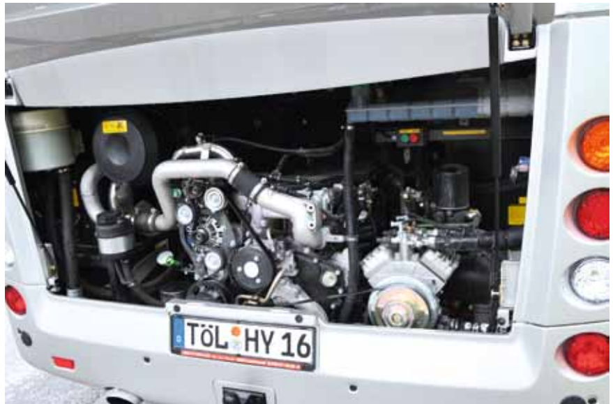
MAN-Triebwerk im Heck: Der D08-Sechszylinder ist jetzt mit 290 PS zu haben
