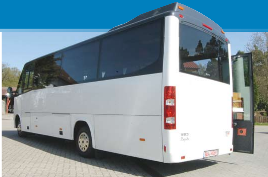
400 Millimeter weniger Radstand, wenn es ein Niederflurheck sein soll
