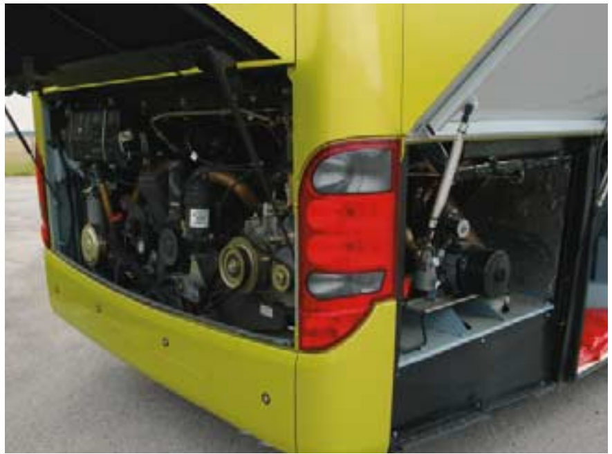
Von allen Seiten gut zugänglicher Motorraum – mittig der stehende Euro-3-Sechszylinder, rechts daneben motorfest der Klimakompressor.
