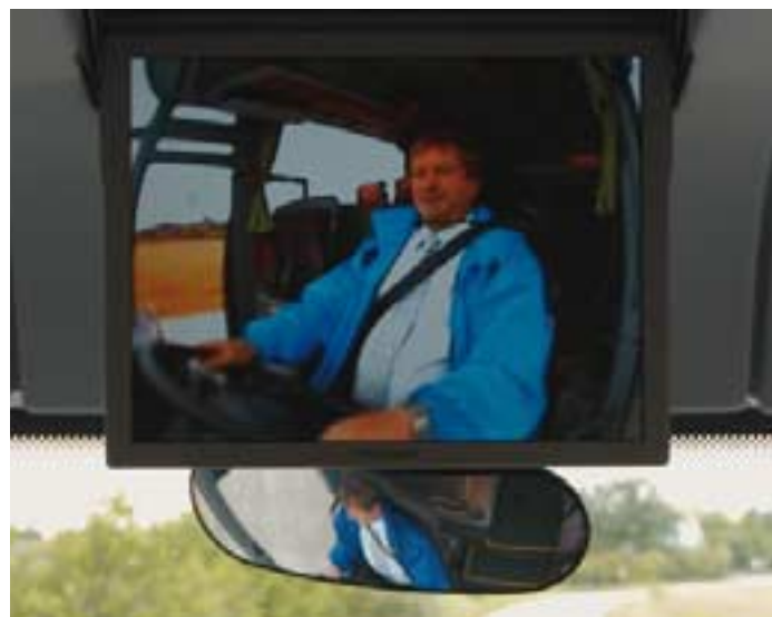
Spricht der Fahrer ins Mikro, überträgt die Kamera sein Bild auf die Monitore.
