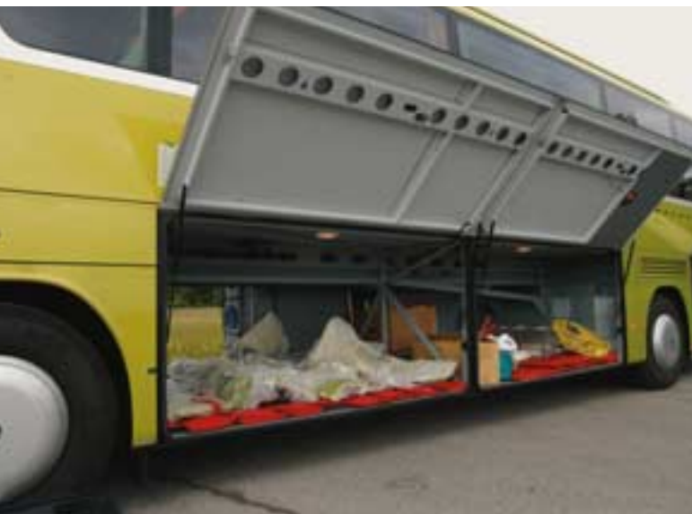
Ausreichend Kofferraum mit einem Fassungsvermögen von maximal 9,6 m 3
