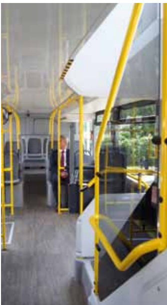
Unterflur im Untergeschoss: Ausreichend Stehhöhe ist gewährleistet, links (im Bild rechts) für eine breite Treppe nach oben.
