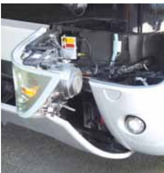
So muss es sein: klappbarer Scheinwerfer für schnellen Zugriff auf defekte Leuchtmittel
