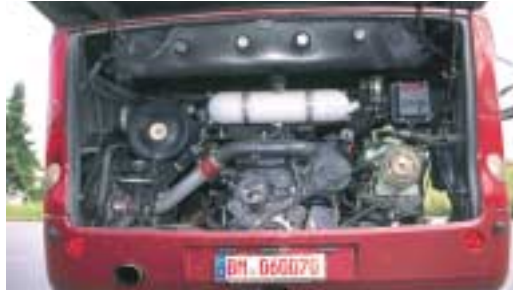
Sparsame Kraftquelle im Heck: stehender Scania Reihensechszylinder mit 12 l Hubraum und 420 PS Nennleistung
