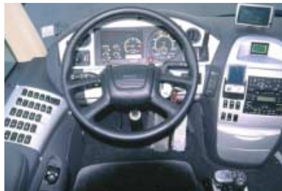
Cockpitatmosphäre im PB: alles gut erreichbar und einzusehen, aber unübersichtliche Schalter für den Karosseriebereich links neben den Armaturen (rechts)
