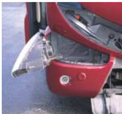
Schnellwechselsystem von Irizar für Scheinwerferbirnen, Reserverad und Wischermotor
