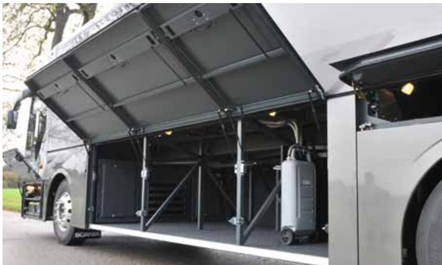
9,1 m 3 großer Kofferraum, separates Staufach über der Hinterachse für den Fahrer
