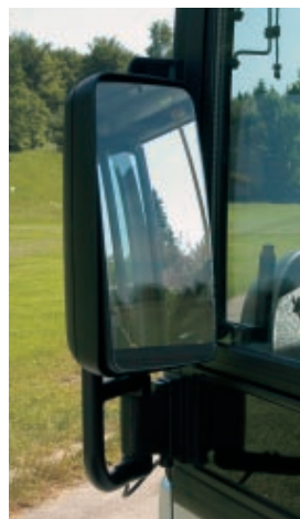
Rustikales Cockpit mit mechanisch verstellbarem Lenkrad. (oben links) Der tief sitzende linke Außenspiegel ist nachts nicht blendfrei.
