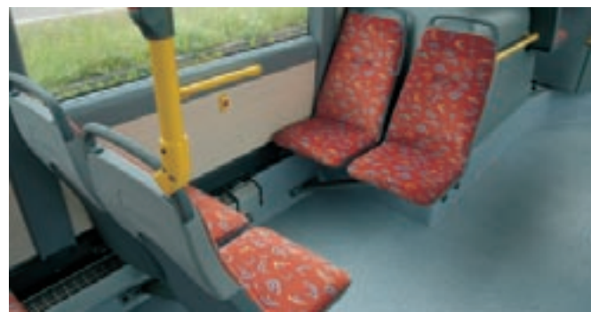
Plastische Heckpartie mit Trapez-Fenster und über die gesamte Breite parallel öffnender Motorklappe (links) Stufenfreie Einstiege und Niederflur im Vorderwagen, ins Heck geht es über zwei Stufen. (rechts oben) Attraktive Cantilever-Sitze aus eigener Fertigung – gelungene Farbwahl (rechts unten)
