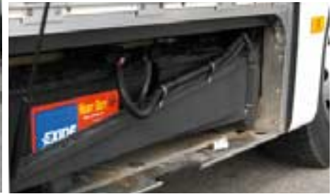
Mitteinstieg mit breiten Außenschwingtüren und Klapprampe (links) Die Batterien vorne links im unfallgefährdeten Bereich
