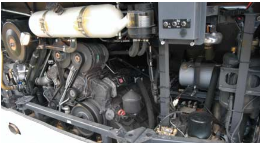
Das Auslaufmodell – der um 60 Grad geneigte Sechszylinder mit mechanischer Einspritzung wird durch einen Euro-4-Fünfzylinder ersetzt.
