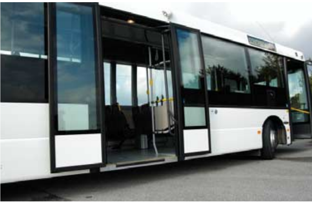
Mitteinstieg mit breiten Außenschwingtüren und Klapprampe (links) Die Batterien vorne links im unfallgefährdeten Bereich
