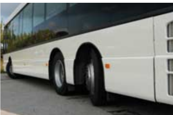
Wendig mit hydraulisch gelenkter Nachlaufachse, große Einschlagwinkel
