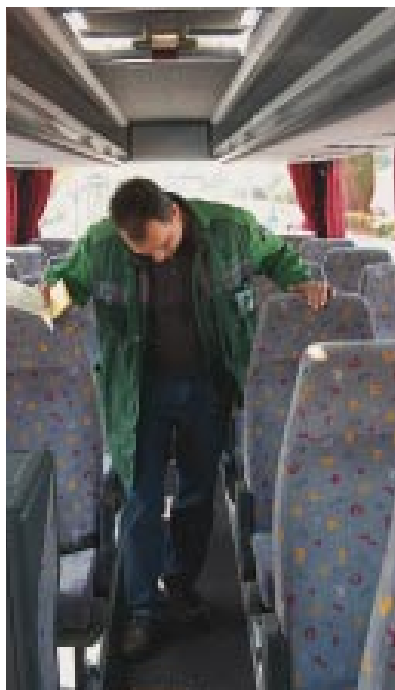
(links) Gegenstand der Untersuchung: die Festigkeit der Einbauten und Sitze, lose Teile werden beanstandet, ebenso klemmende Dachklappen. (rechts) Nicht zuletzt das Fahrlicht wird geprüft.
