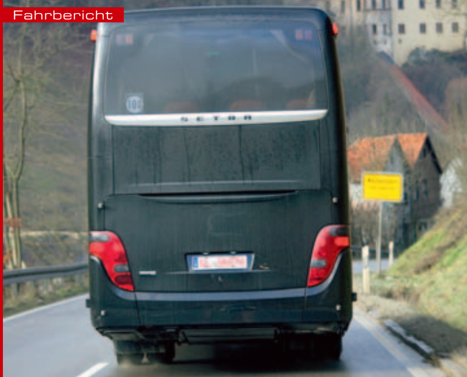
Der schmalere Lüftungsschlitz der Heckklappe zieht weniger Schmutz nach innen.
