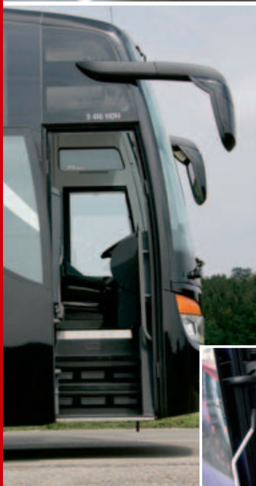
200 Millimeter mehr Vorbau – für einen breiteren Einstieg, für mehr Platz fürs Personal.
