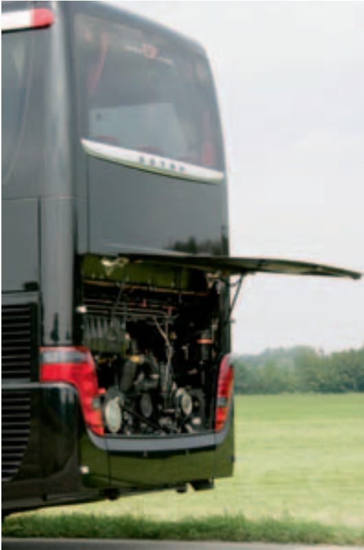
Die Schwenkklappe spart Gewicht und schützt bei Regen
