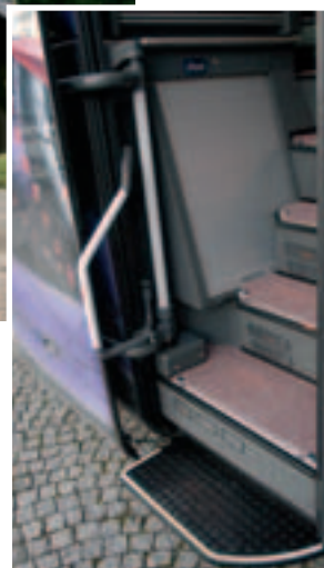
Exklusiv im HDH: Öffnet die Mittel-tür, wandert mit der Einstiegsstufe ein Handgriff nach außen.
