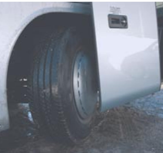
Vorsicht mit offener Vordertür - größere Lenkwinkel sind nur mit geschlossener Tür möglich.
