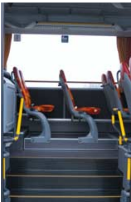
Breite Türöffnung, gleich gegenüber die Wechselplattform für den Stehperron.
