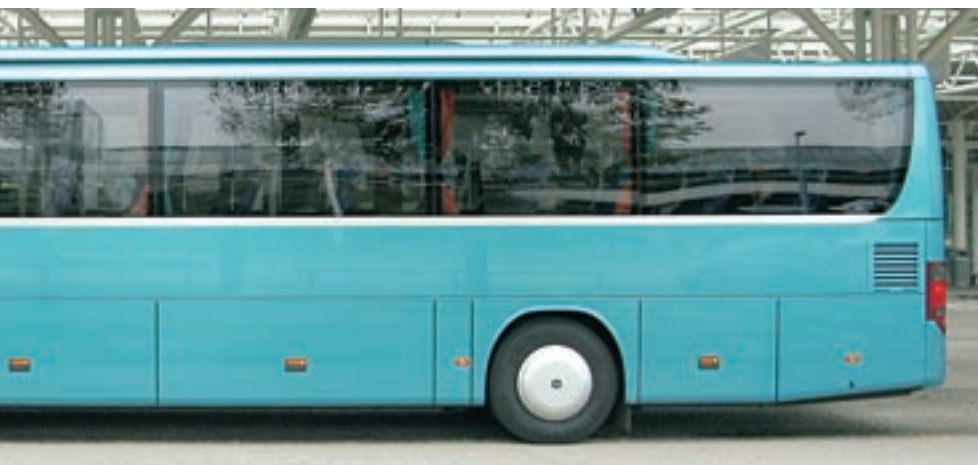
(oben links) Der Stadt-Land-Autobahn-Bus: das Hochboden-Modell Setra S 415 GT für zahlreiche Einsatzfälle. (unten links) Schlichtes Heck, praktische Anfahrrecken. (oben rechts) Auch mit 20 cm verlängertem vorderen Überhang harmonische Proportionen – die Klimaanlage in Dachmitte
