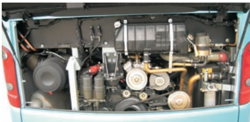
(oben) Knapper Bauraum für den liegenden Reihensechszylinder DM 457 hLA mit 408 PS, darüber der motorfeste Klimakompressor (rechts) Für Fernreisen und Transferfahrten limitiert durch 6,7 m 3 Kofferraum
