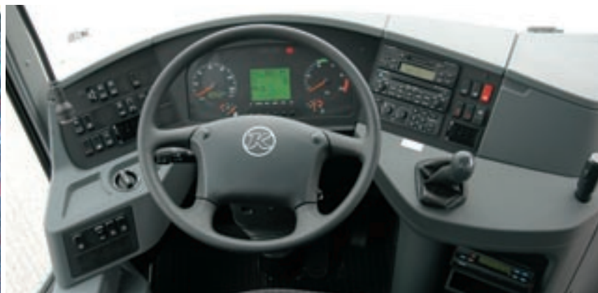
(links) Mut zur Farbe – bequeme Sitze aus konzerneigener Fertigung, ein breiter Mittelgang mit gutem Zugang zum Handgepäck. (rechts) Comfort-Class-Cockpit mit viel Platz – sauber verarbeitetes Armaturenbrett mit betont sachlicher Note, Joystick-Schaltung
