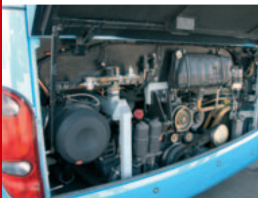
Regio mit D20-Sechszylinder und 350 PS – stark und kultiviert, aber wenig wartungsfreundliche Einbaulage.
