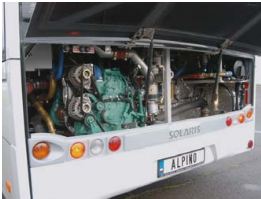
Stehender Euro-4-Sechszylinder im Heck – auch Solaris setzt auf SCR-Abgastechnik. rechts: 13 Sitzplätze plus (rein rechnerische) 68 Stehplätze lässt die Nutzlast des Alpino zu.
